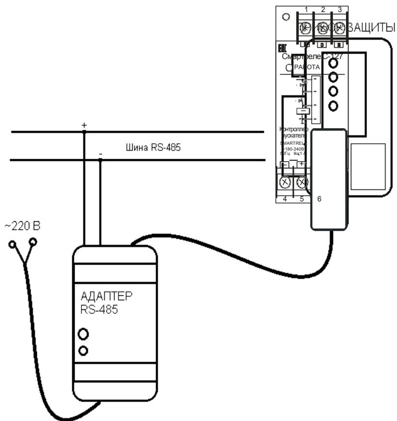
Рисунок 9 – подключение адаптера RS-485
