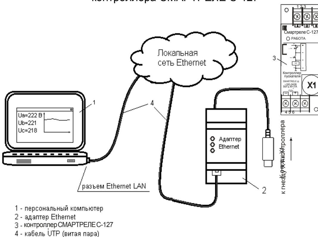
Рисунок 8 – подключение контроллера СМАРТРЕЛЕ С-127 при помощи адаптера Ethernet
