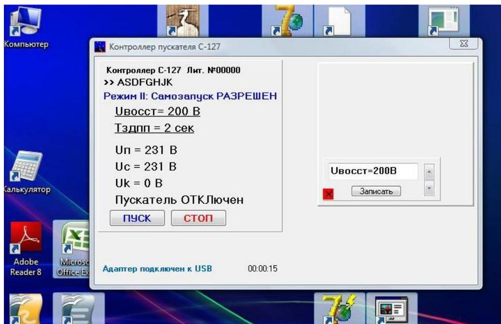
Рисунок 7 – окно корректировки настроек параметров контроллера СМАРТРЕЛЕ С-127
